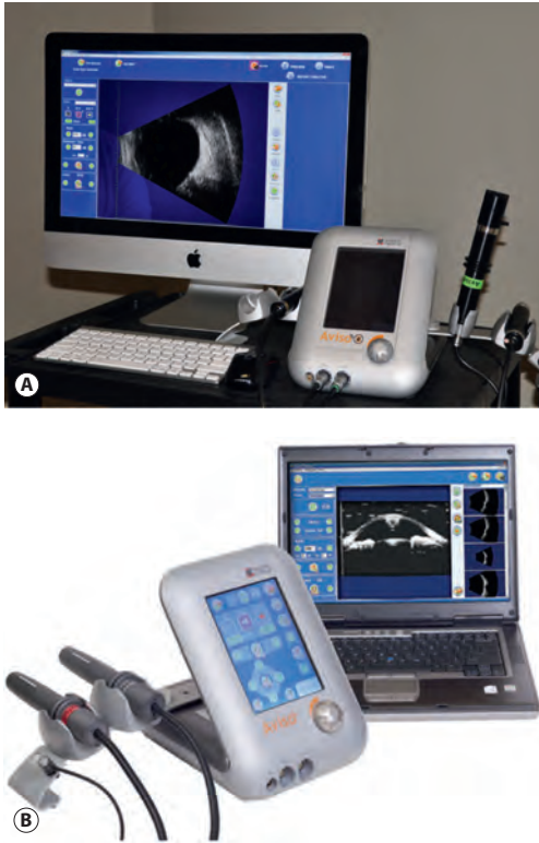
Рис. 2.2 Аппараты для УБМ: стационарный (А) и переносной (В). (Цит. по: Quantel Medical, Бозмен, Монтана, США; с разрешения.)
